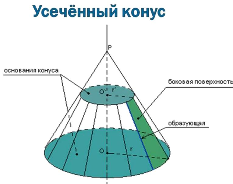
14) Площадь боковой поверхности усеченного конуса равна произведению полусуммы длин окружностей оснований на образующую:  $S_{\text{кон}} = \pi(r + r_1)l$ , где  $r$  и  $r_1$  – радиусы оснований,  $l$  – образующая усеченного конуса.
